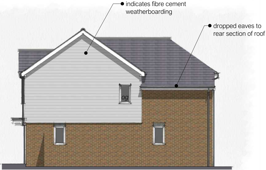
south west elevation og = obscure glazed
